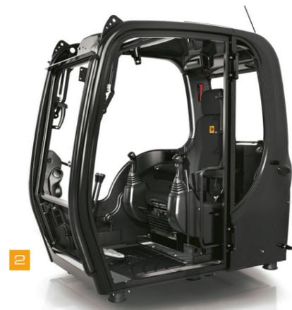
2 Para aumentar a segurança do operador, a cabine da linha NXT conta com proteção contra capotamento (ROPS). Também disponibilizamos de forma opcional proteções contra queda de objetos (FOPS), que são de fácil instalação graças à estrutura padrão da cabine de todos modelos da linha NXT da JCB. Para maiores informações consulte seu distribuidor JCB local.
