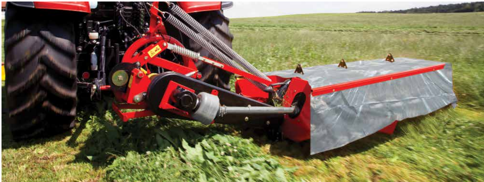
Segadora de Discos MF DM 1358 , não esmaga a forragem, corte suave e menos perdas
