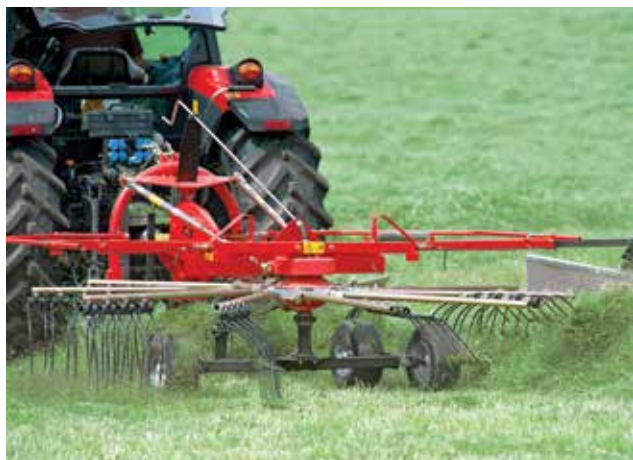
Enleirador MF RK 3802 DN , permite ajustagem da largura e flexibilidade total dos braços
