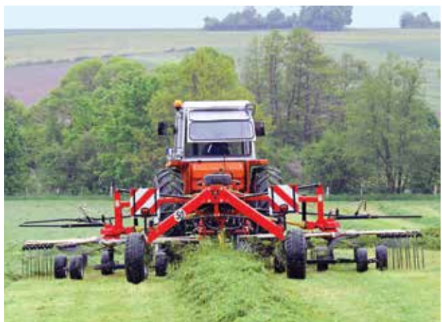
Enleirador de Duplo Rotor MF RK 3875 , total ajustagem na posição de trabalho, com reduzida altura de transporte
